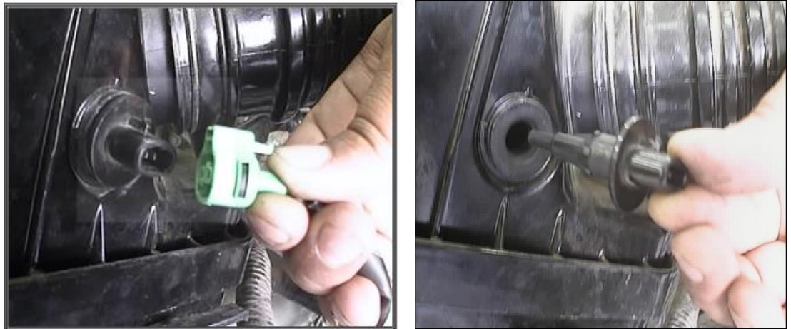
شكل رقم 3- يمثل حساس حرارة الهواء الداخل للمحرك
