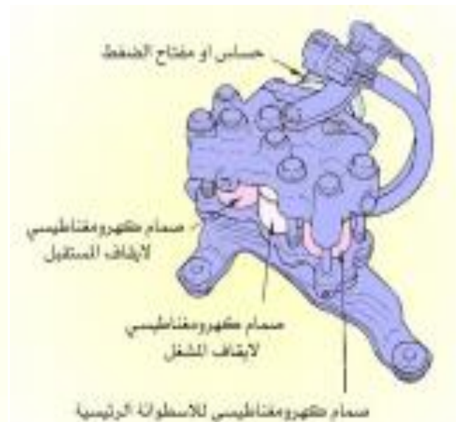
شكل رقم (١٦١) يبين أجزاء مشغل الفرامل
