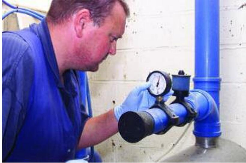
شكل يوضح فحص مقياس تخلخل الضغط قبل البدء بعملية الحلب
