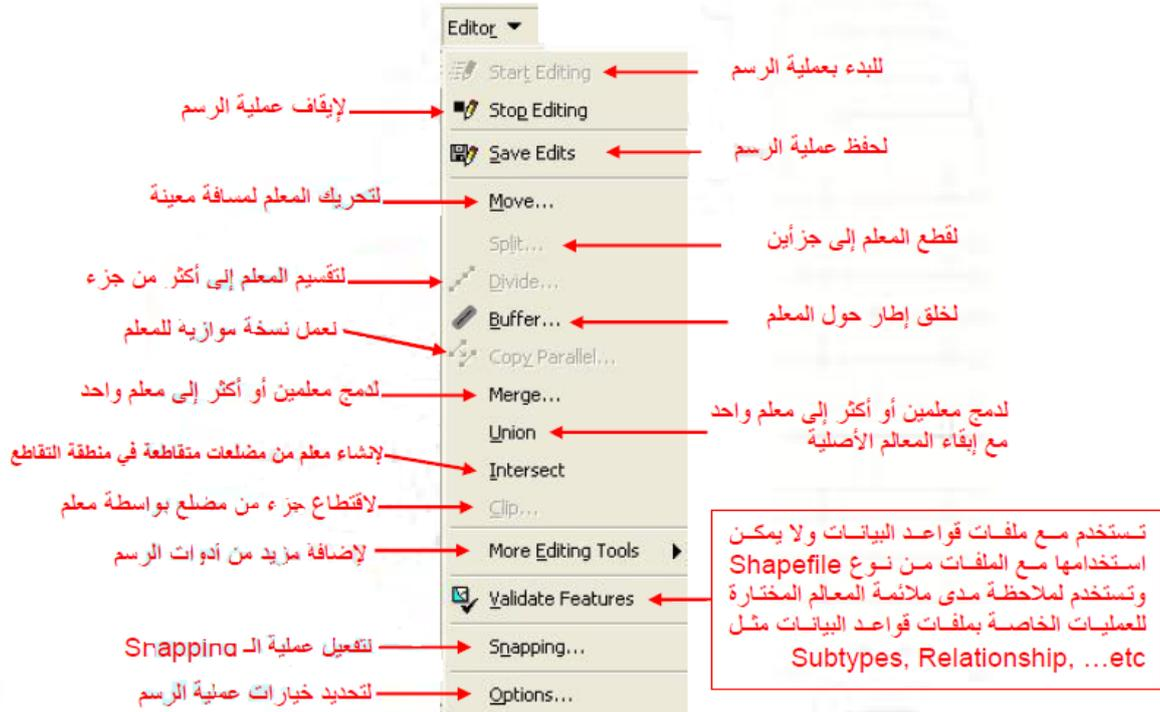
**امر Move :-** ويستخدم لتحريك العوارض عن طريق الاختلاف في قيم ال (X,Y) لاحظ الشكل رقم (٥,٥)
