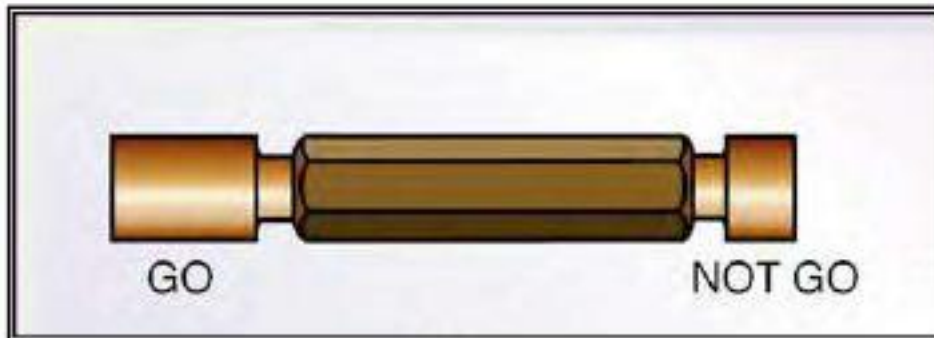
الشكل رقم (3-14) : مُحدد قياس سداي ثنائي الطرف
