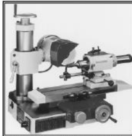
الشكل رقم (8-12) : مكنة نجليخ قواطع التفريز الآلفية
